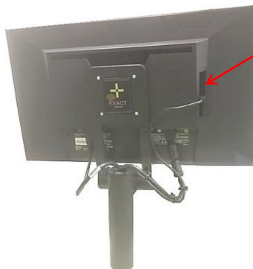
Figur 8: USB-kontakter bak på monitoren (tilgjengelig i noen ExactVu-systemkonfigurasjoner)
