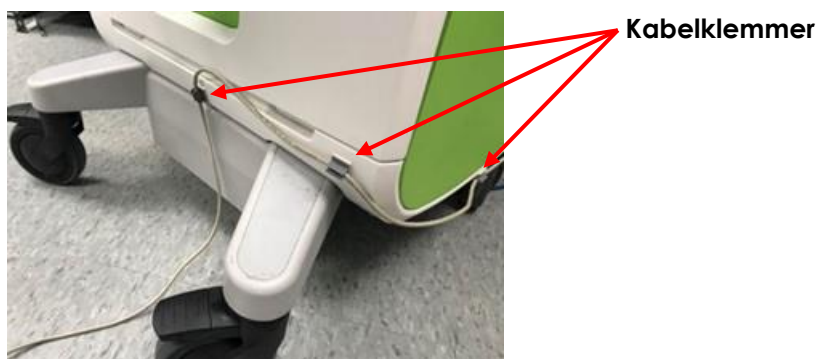
Figur 4: Håndtering av fotpedalkabelen
