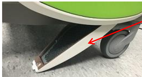
Figur 69: Tilgang til nedre luftfilter
