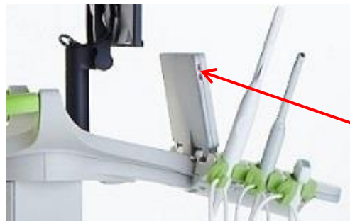
Figur 7: USB-kontakter på venstre side av berøringsskjermen
