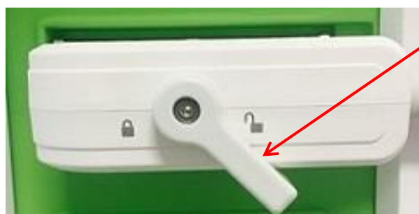
Figur 30: Låseknott for probetilkobling i ulåst posisjon
